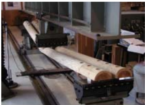
材料試験 ( 林業総合センター実施 ) ビームの曲げ強度試験状況
