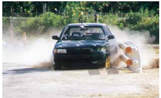
衝突角度20° 衝突速度60km/h
