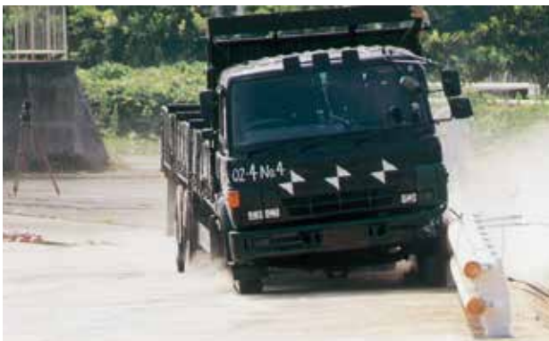
防護柵の強度及び車両の誘導性を確認
