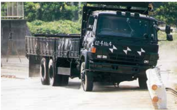
衝突角度15° 衝突速度30km/h
