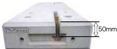
ボルト引抜抵抗の作用点 上面より50mm JIS B 8562で規定するアンカーの有効埋め 込み深さに準拠
