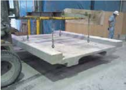
一時養生実施後に 90°C、48 時間の二次養生を実施
