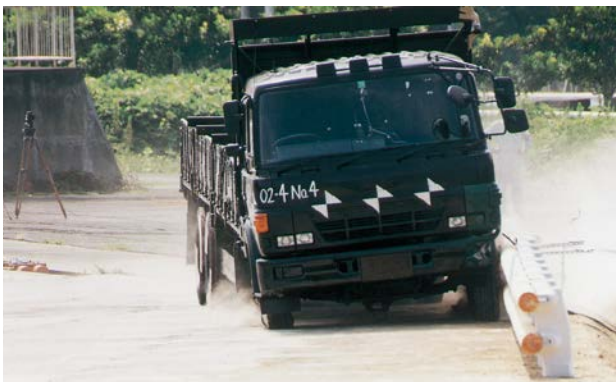
防護柵の強度及び車両の誘導性を確認
